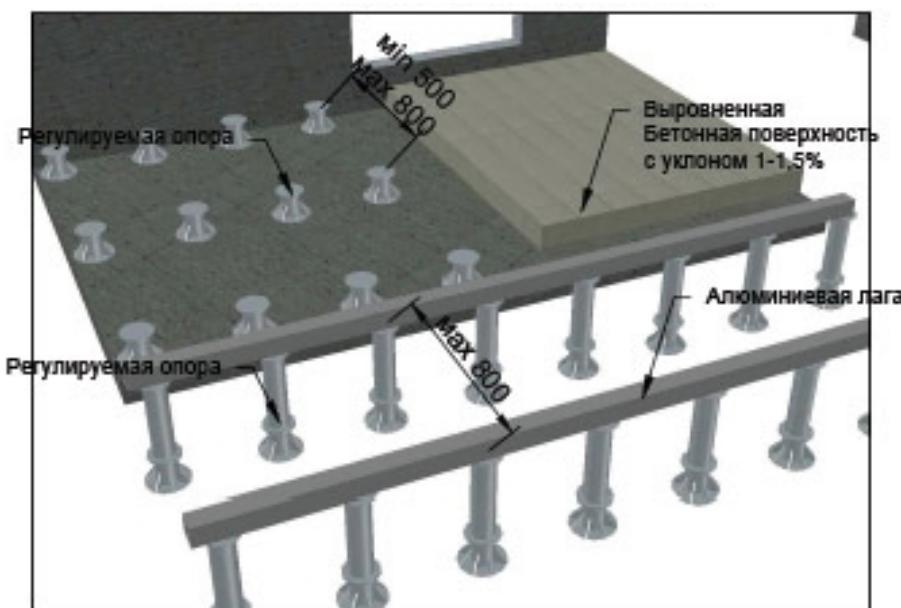
В целях защиты уплотнительного покрытия от механических повреждений под опоры должны подкладывать полимерные подкладки или подкладки из отрезков защитного строительного мата размером на 100 мм больше основания опоры. Укладка защитного мата по всей площади не требуется.
